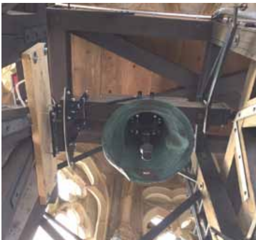
Links im Bild der Drehstrommotor einer elektrifizierten Glocke
